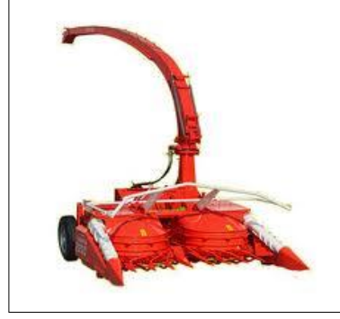
Şekil 1. Denemelerde kullanılan iki ve dört sıralı silaj makinaları
