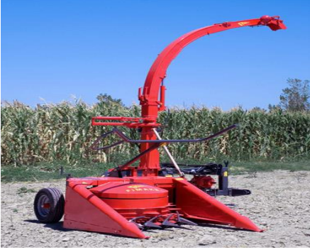
Şekil 1. Denemelerde kullanılan iki ve dört sıralı silaj makinaları
